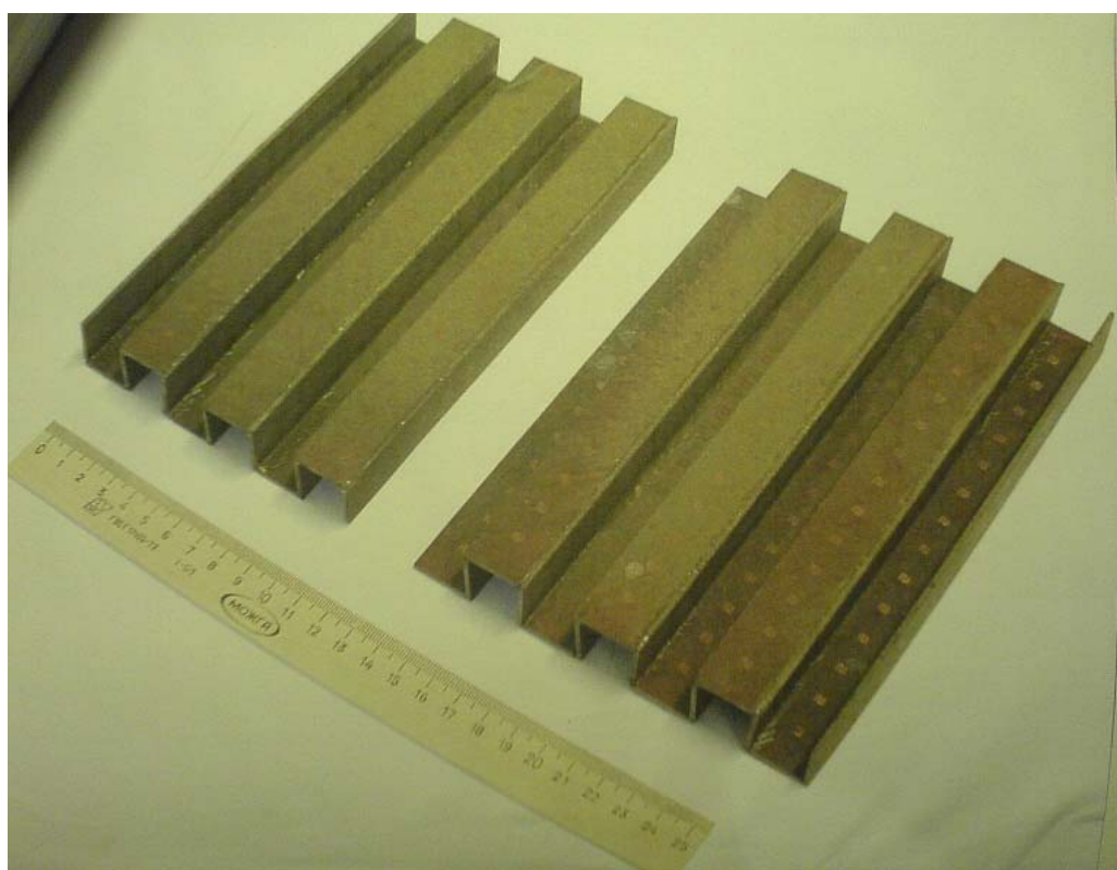
Рисунок 4.10 — Образец гофрированного кирального покрытия на основе S-элементов
